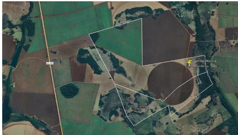
Com o croqui definido, foram criados os pontos nos vértices, onde os marcos físicos deveriam ser implantados. Esses pontos foram carregados na controladora do equipamento GPS, permitindo que, no campo, o operador localizasse o ponto exato para a implantação dos marcos. A instalação desses marcos variou conforme a qualidade do sinal de GPS. Em áreas com bom sinal, o processo de fixação foi rápido, levando cerca de cinco segundos para registrar o ponto. Entretanto, em áreas com vegetação
