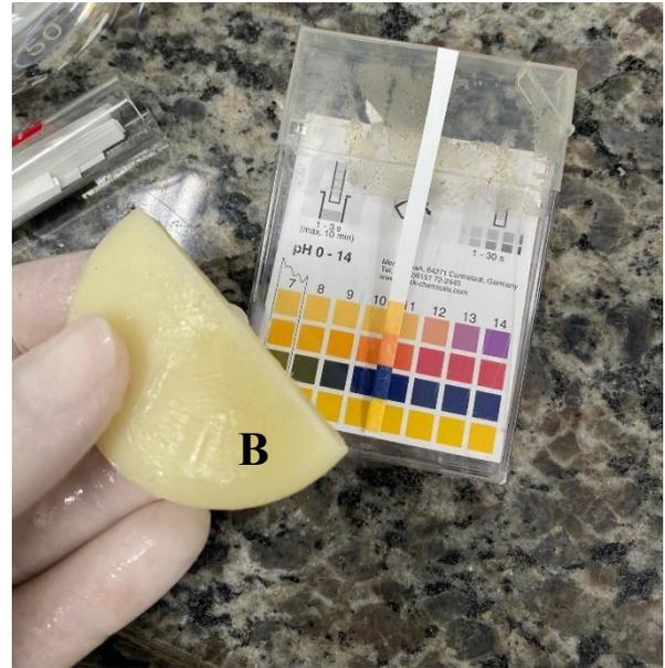
**Figura 4** – Medindo pH com fita em contato com a amostra
