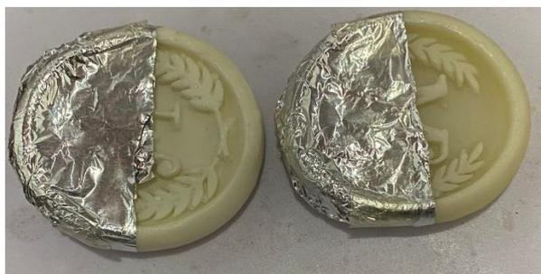
Figura 1 – Primeiro dia do teste de resistência a luminosidade
