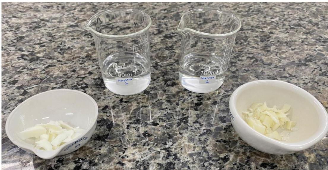
**Figura 5** – Medindo pH com raspas das amostras em diluição
